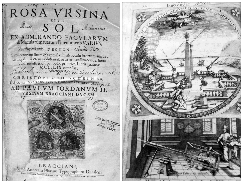
Fig. 5 Christophor Scheiner, Rosa Ursina sive Sol , Bracciani, 1626–1630. În stânga, pagina de titlu, în dreapta, instalația pentru trasarea diagramelor petelor solare. Aceasta din urmă avea o instalație care permitea mutarea lunetei, pentru a menține imaginea soarelui pe ecranul pe care era proiectată.
