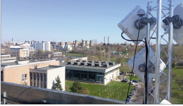
Fig. 2. Senzor bistatic cu emițător de tip oportunist într-o configurație spațială: bistatic la sol/monostatic satelitar
