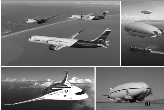
Fig. 15. – Diferite concepte de dezvoltare pentru aeronave de pasageri și utilitare, având motoare cu alimentare hibridă (hidrogen lichid și combustibil de aviație). Compania Airbus și-a propus să înceapă operațiunile comerciale până în 2035 (colaj original de fotografii din colecțiile Airbus și Lockheed Martin).
