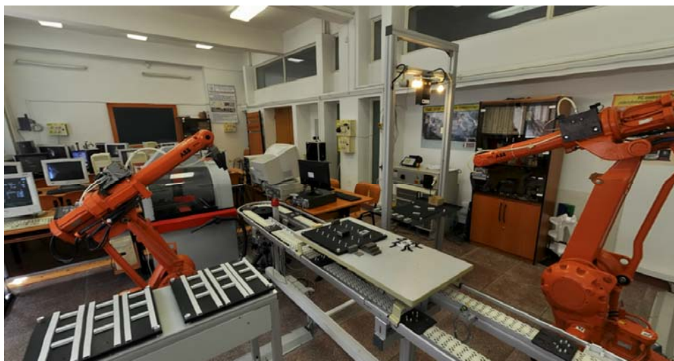
Sistem flexibil de fabricație integrat cu calculatorul: unitate centrală de conducere, doi roboți industriali, sistem de vedere artificială și de recunoaștere a formelor, mașină unecaltă și conveier, și rețea de calculatoare pentru programare și instruire.
