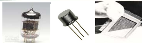
Calculatorul DACICC 1 cu tuburi electronice, tranzistoare și memorie pe ferită.
