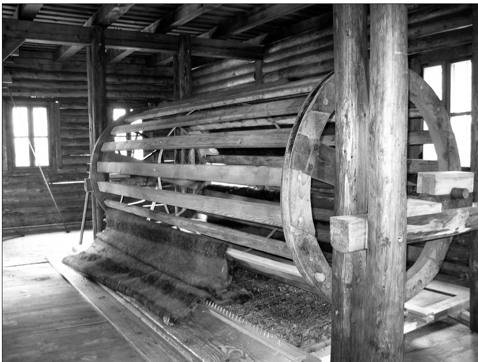
Fig. 7b – Complexul de instalații tradiționale acționate hidraulic specializate în finisarea texturilor groase de la Lisa, jud. Brașov: dârsta pentru straie (2002).
