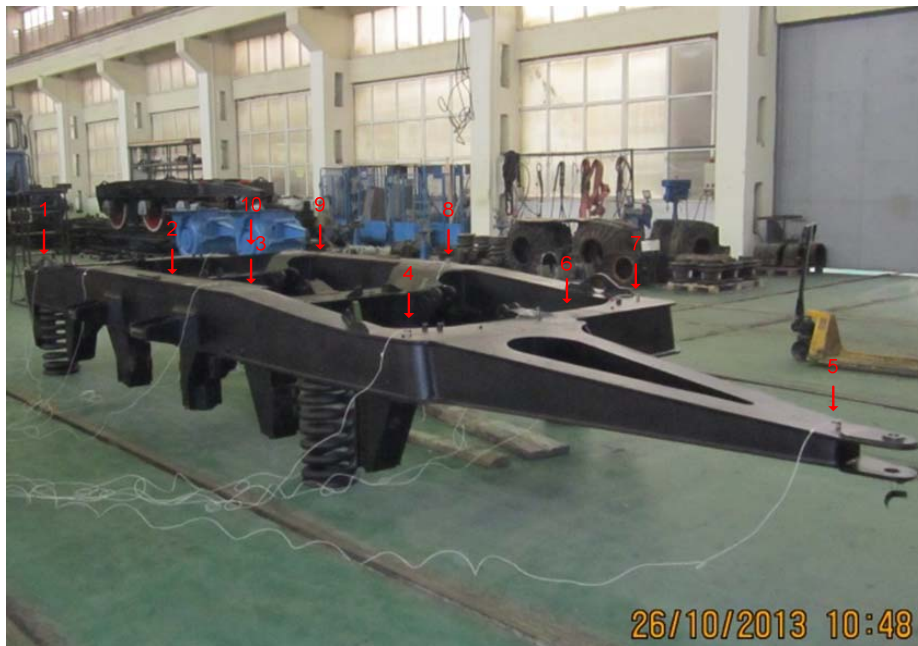
Fig. 2 – EM analysis of LEMA 5 100 kW bogie frame.
